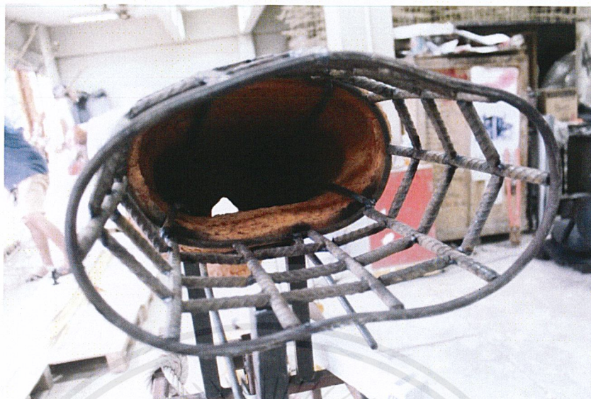
ภาพที่ 99 ดามงานทั้งสองส่วนเข้าด้วยกัน โดยเชื่อมเหล็กเป็นโครงสร้างภายในของชิ้นงานดินเผา
