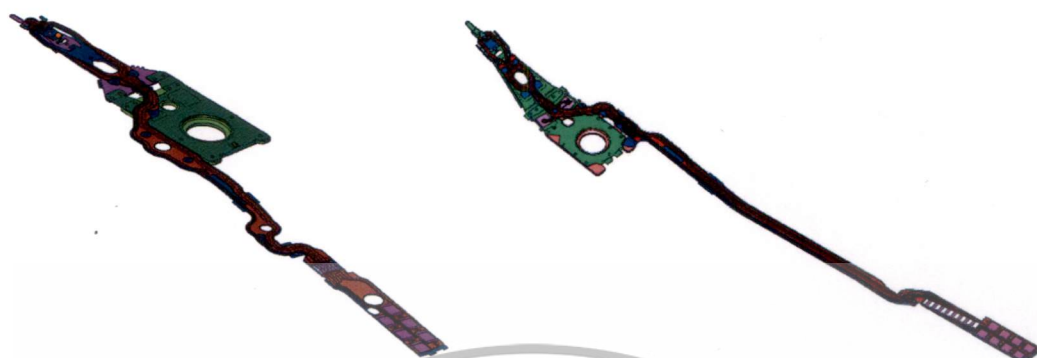
รูปที่ 4.9 ชุดจับยึดหัวอ่านเขียน (ก) แบบซิงเกิลสเตทแอกซ์ฮวีเอเตอร์ (ข) แบบคูอัลสเตทแอกซ์ฮวีเอเตอร์
