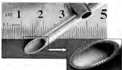
รูปที่ 2.10 สันครีบบขนาดเล็กภายในท่อทองแดงของ Tang et al. [9]
