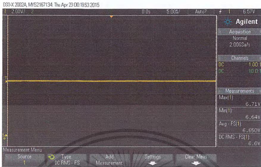
รูปที่4.11 สัญญาณไฟเลี้ยงบอร์ดไมโครคอนโทรลเลอร์
