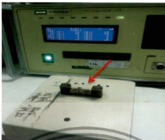
รูปที่ 3.63 ลักษณะการจับชิ้นงานเพื่อทำการวัดค่า t_{tr} ของไดโอดที่ประกอบตัวถังแล้ว ด้วยเครื่อง TVR 6000
