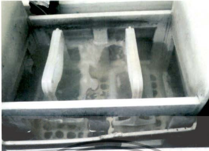
รูปที่ 3.41 แผ่นเวเฟอร์ที่จมในบ่อ ซึ่งมีส่วนผสมของ \text{HFNO}_3 \text{C}_2\text{H}_4\text{O}_2
