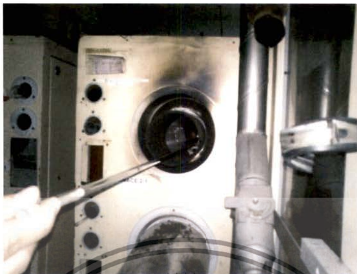
รูปที่ 3.43 เตาที่ใช้แผ่นเวเฟอร์ ทำการลอกน้ำยาไวแสง
