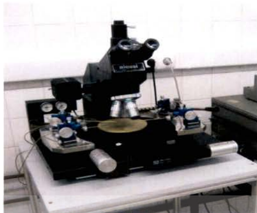
รูปที่ 3.65 หัววัด Cascade Microtech Model M150
