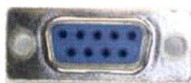
รูปที่ 2.4 พอร์ตอนุกรม DB9 ตัวเมีย (Female)
