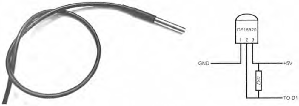
ภาพที่ 5.37 โพรบวัดอุณหภูมิในน้ำสารละลายอาหาร
