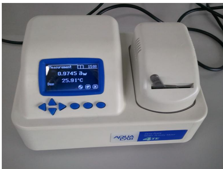
ภาพผนวกที่ ก1 เครื่อง Water Activity Meter
