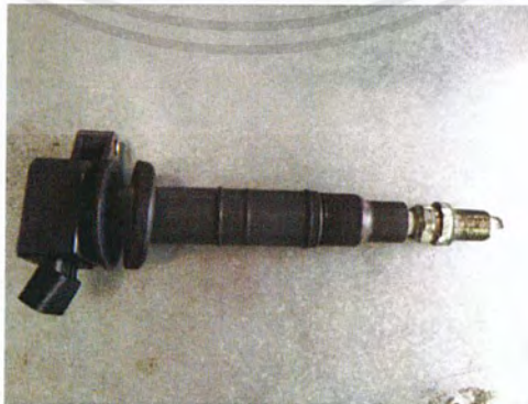
รูปที่ 8. แสดงการต่อคอยล์กับหัวเทียนแบบ Direct Coil
