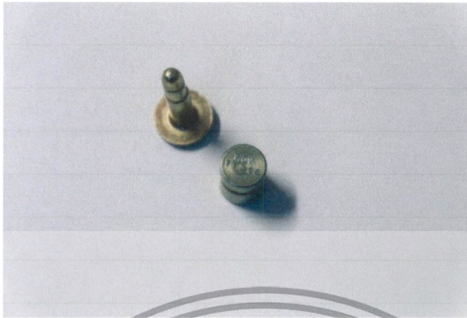
รูปที่ 4.21 แสดงน็อตที่ใช้ยึดแผ่นป้ายทะเบียน ซึ่งมีเลขรหัสประจำ
