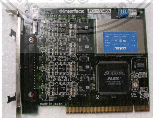
รูปที่ ก.3 ภาพถ่ายการ์ดแปลงสัญญาณดิจิทัลเป็นแอนะล็อก
