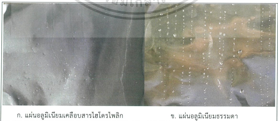
รูปที่ 3.6 การทดสอบการไหลของหยดน้ำในทิศทางทำมุม 90^{\circ} กับพื้น
