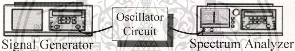
รูปที่ 4.3 การทดลองของวงจรกำเนิดสัญญาณที่ประยุกต์ใช้ในการย้ายย่านความถี่ขึ้นและลง
