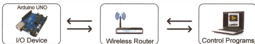
รูปที่ 3.26 การทำงานของ Wireless Router
