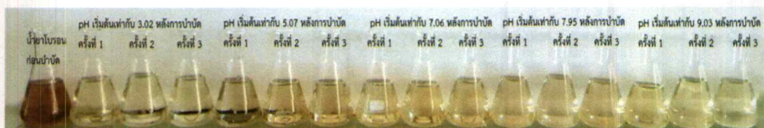
รูปที่ 4.9 ลักษณะสีของน้ำยาโบรอนก่อนการบำบัดและหลังการบำบัดที่ pH เริ่มต้นเท่ากับ 3.02 , 5.07, 7.06, 7.95 และ 9.03 ของครั้งที่ 1, 2 และ 3 ตามลำดับ
