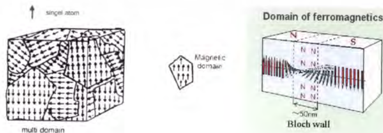
รูปที่ 2.35 ภาพจำลองการอธิบายถึงโดเมนในวัสดุที่มีสภาพแม่เหล็กแบบเฟอร์โร หรือเฟอร์ริแมกเนติก
