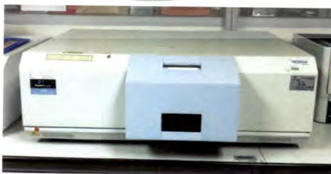
รูปที่ 3.8 เครื่องฟลูออเรสเซนซ์ สเปกโตรสโกปี (Fluorescence Spectroscopy) รุ่น Perkin-
