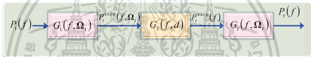
รูปที่ 3.5 บล็อกไดอะแกรมสูตรการส่งผ่านสัญญาณของฟรีสสำหรับระบบการสื่อสารทั่วไป
