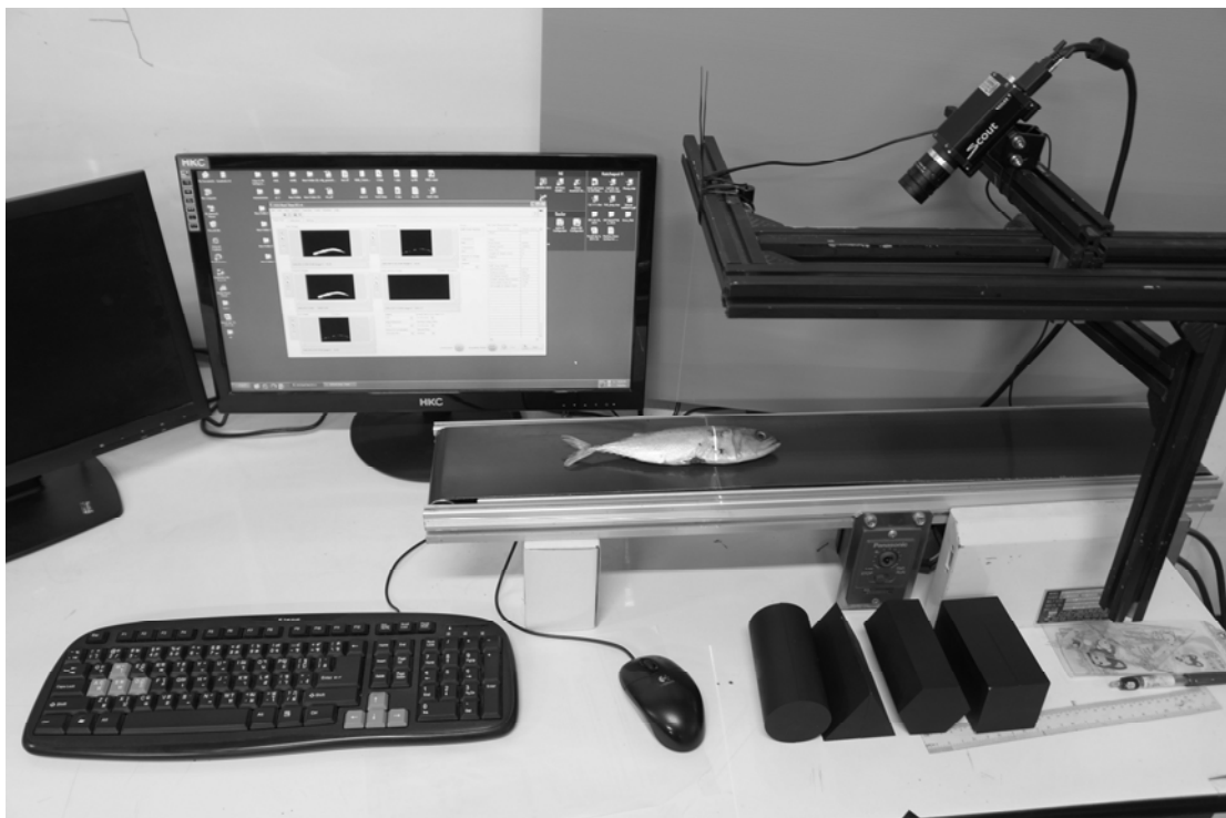
รูปที่ 5.3 ระบบตรวจวัดปริมาตรและคัดแยกขนาดของปลาแบบต่อเนื่อง
