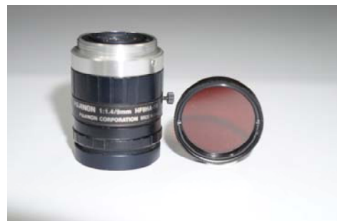
รูปที่ 5.2 เลนส์และตัวกรองคลื่นแสงย่านสีแดง (620-650 Narrow band pass filter)
