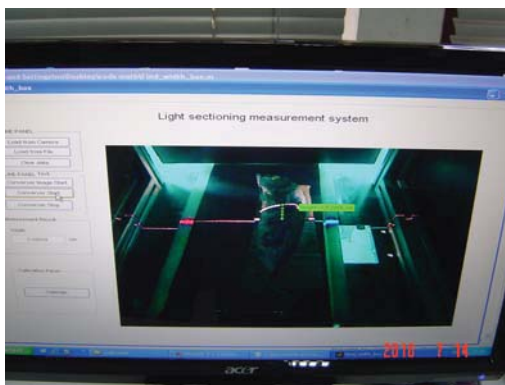
ภาพที่ 4 โปรแกรม MATLAB GUI กับการทดสอบกับการวัดขนาดปลา
