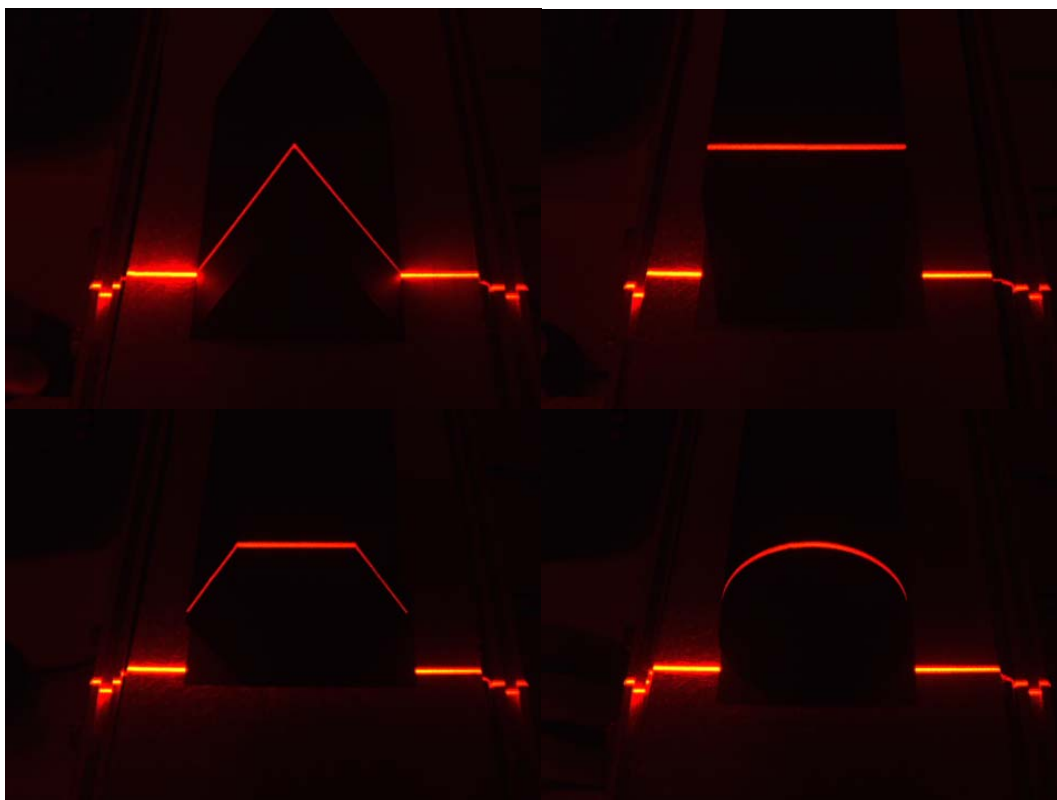
รูปที่ 4.2 แสดงระบบแสงเลเซอร์ตัดขวางที่ตกกระทบกับพื้นผิวของวัตถุตามการเคลื่อนที่ของวัตถุ
