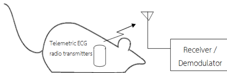
รูปที่ 4.3 การวัดสัญญาณ ECG และการเคลื่อนไหวของหนูทดลองด้วยระบบ Biotelemetry system
