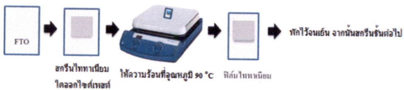
รูปที่ 3.5 ขั้นตอนการเตรียมฟิล์มไททาเนียมไดออกไซด์
