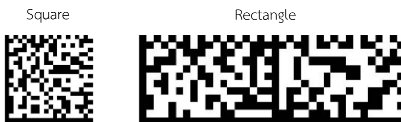
รูปที่ 1.4 รหัสแท่ง 2 มิติมาตรฐาน Data Matrix [6]
