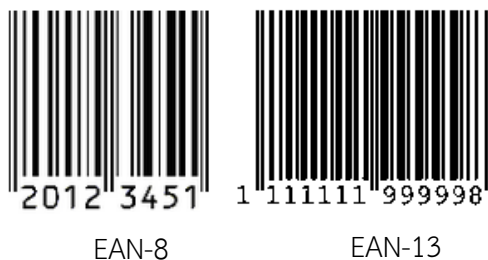
รูปที่ 1.2 รหัสแท่ง 1 มิติมาตรฐาน EAN-8 และมาตรฐาน EAN-13 [3]
