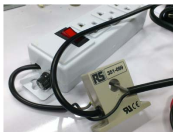
รูปที่ 3.6 การเชื่อมต่อทรานส์ดิวเซอร์กระแสเข้ากับสายไฟเพื่อทำการวัดกระแสไฟฟ้า
