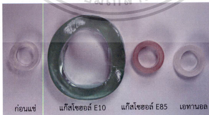
รูปที่ 5.20 ท่อยาง Tygon 2075 หลังจากการแช่ 168 ชั่วโมง
