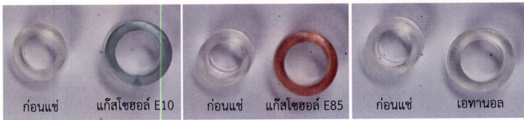
รูปที่ 5.17 ท่อยาง Superthane หลังจากการแช่ 168 ชั่วโมง
