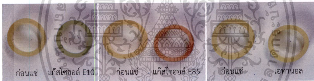
รูปที่ 5.19 ท่อยาง Tygon F-4040-A หลังจากการแช่ 168 ชั่วโมง
