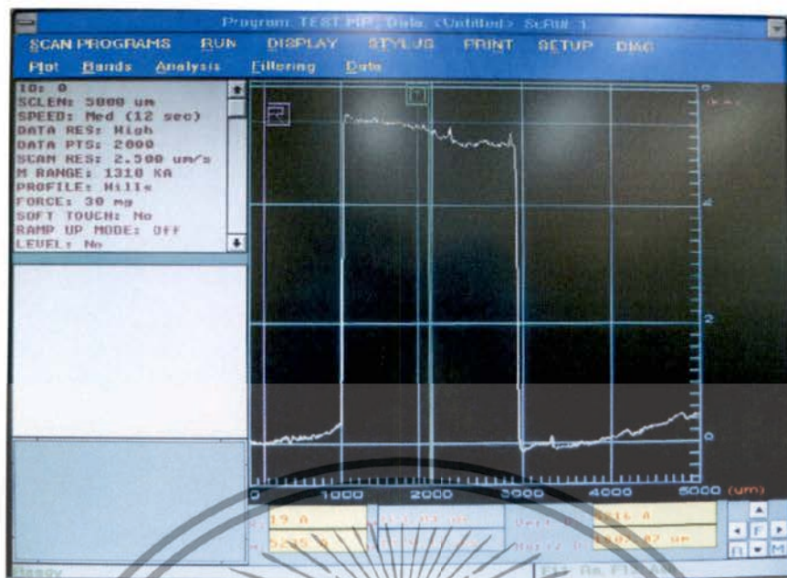
รูปที่ 4.2 ค่าความหนาที่วัดได้จากเครื่องวัดความหนาฟิล์ม (Surface profiler) ของฟิล์มบาง W002
