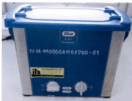
รูปที่ 3.3 อ่างล้างความถี่สูง Elmasonic รุ่น E30H
