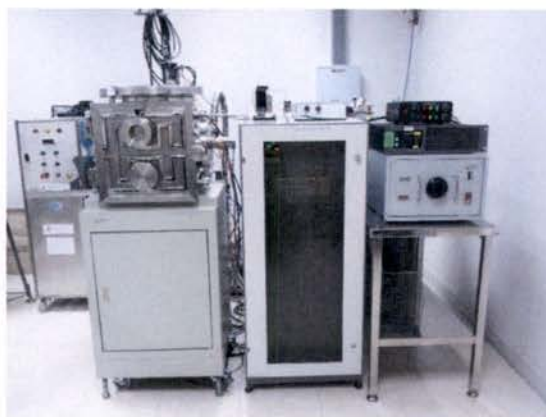
รูปที่ 3.1 แสดงเครื่องสเปคโตริง ระบบ ดีซี แมกนีตรอน สเปคโตริงที่ใช้ในการทดลอง
