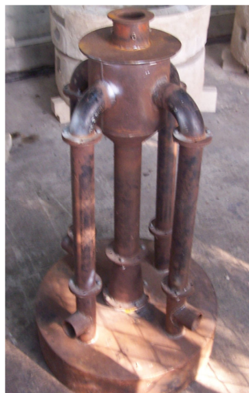
รูปที่ 4.3 หัวเผาเชื้อเพลิงผงแบบมีการหมุนเวียนแก๊สไอเสีย [16]
