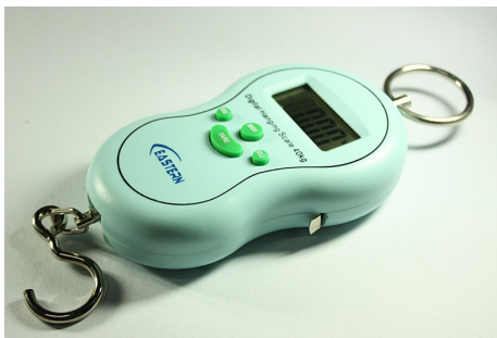
รูปที่ 4.8 เครื่องชั่งดิจิตอลสำหรับวัดโมเมนต์ในแนวสัมผัสเชิงมุม
