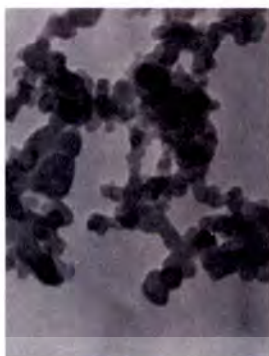
รูปที่ 2.3 ลักษณะรูปร่างของอนุภาคนาโน \text{TiO}_2 [18]
