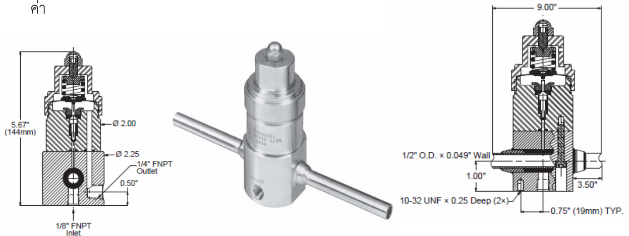
ภาพที่ 2.9 เครื่องมือเปลี่ยนสถานะก๊าซ Steam Heated Regulators HPR-2 Series บริษัท GO Company
