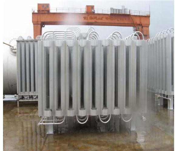
ภาพที่ 2.8 เครื่องมือเปลี่ยนสถานะของก๊าซที่ใช้ตามปั๊มเติมก๊าซ เอนจิวิให้กับรถยนต์ ที่มา : http://en.wikipedia.org/wiki/Evaporator
