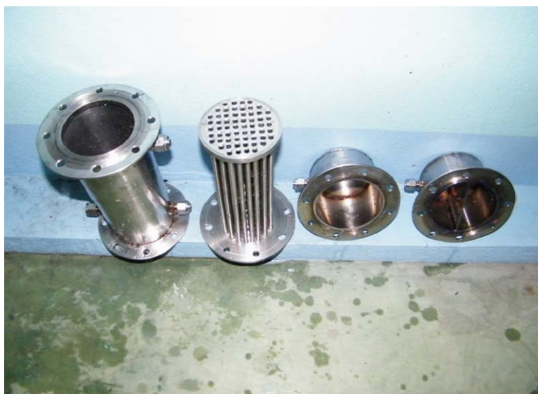
ภาพที่ 6.10 เครื่องมือเปลี่ยนสถานะของก๊าซโดยการใช้พลังงานความร้อนจากไอน้ำที่พัฒนาขึ้นมาใหม่หลังจากการทำความสะอาดความร้อนจากไอน้ำ
