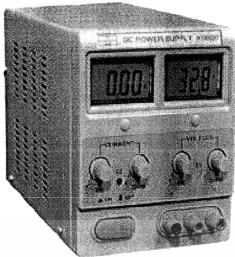
ภาพที่ 2.20 ชุดจ่ายไฟ Power Supply
