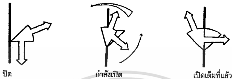
รูปที่ 2.16 แสดงการเคลื่อนไหวที่ของกลไกตามหลักการของการพับมุม 45 องศา
