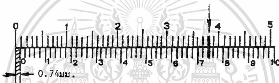
ภาพที่ 24 เมื่อขีดสเกลที่ 35 ขีด สเกลศูนย์เยื้องกัน = 0.74 มม.
