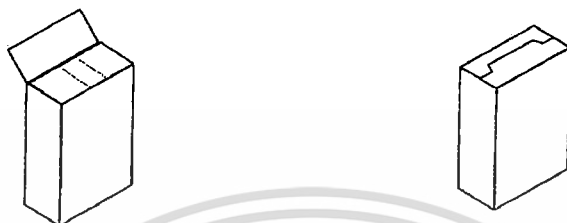
ค. กล่องปิดท้ายด้วยการผนึกยาว (Seal-end carton) ง. กล่องปิดท้ายด้วยกลไกล็อก (Lock-end carton)
