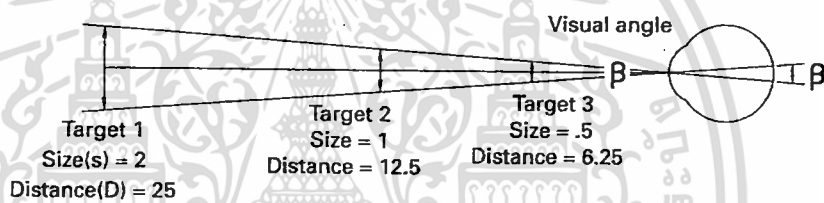
ภาพที่ 2.22: แสดงขนาดวัตถุที่สัมพันธ์กับระยะห่าง
