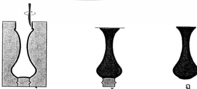
ภาพที่ 2.60 การขึ้นรูปด้วยวิธีการหล่อกลวง
