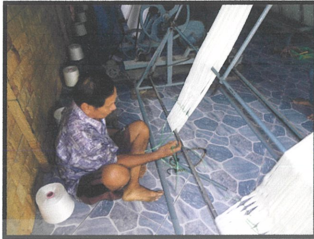
ภาพที่ จ6 ใช้เชือกฟางมัดเพื่อไม่ให้ไหมแตกออกจากกัน แล้วถอดออกจากเครื่องคันหมี จากนั้นนำไปใส่โหลงหมี
