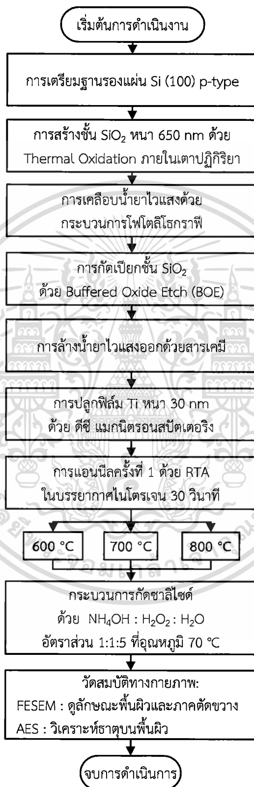
รูปที่ 3.20 แสดงผังงานของการกัดเปียกชั้นไทเทเนียมที่ไม่เกิดซิลิไซด์ด้วยกระบวนการกัดซาลิไซด์ เอกสารนี้เป็นเอกสารที่สงวนไว้สำหรับการใช้งานเพื่อการศึกษาเท่านั้น ไม่อนุญาตให้นำไปใช้ประโยชน์ด้านการค้า ไม่ว่าจะกรณีใดๆ ทั้งสิ้น อีกทั้งห้ามมิให้ดัดแปลงเนื้อหา และต้องอ้างอิงถึงเจ้าของเอกสารทุกครั้งที่มีการนำไปใช้
