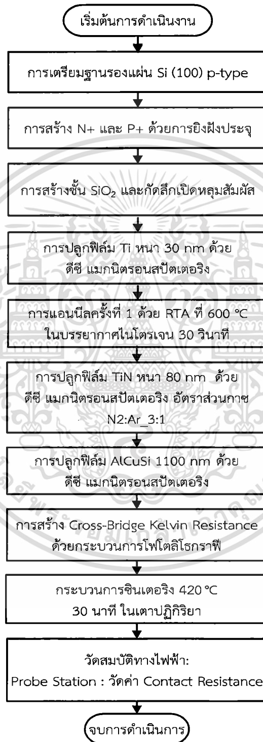
รูปที่ 3.32 แสดงผังงานของการสร้างรอยสัมผัสไทเทเนียมซิลิไซด์กับฐานรองซิลิคอนด้วยกระบวนการซาไลซ์ที่แอนนีสด้วยความร้อนแบบรวดเร็วครั้งเดียว
