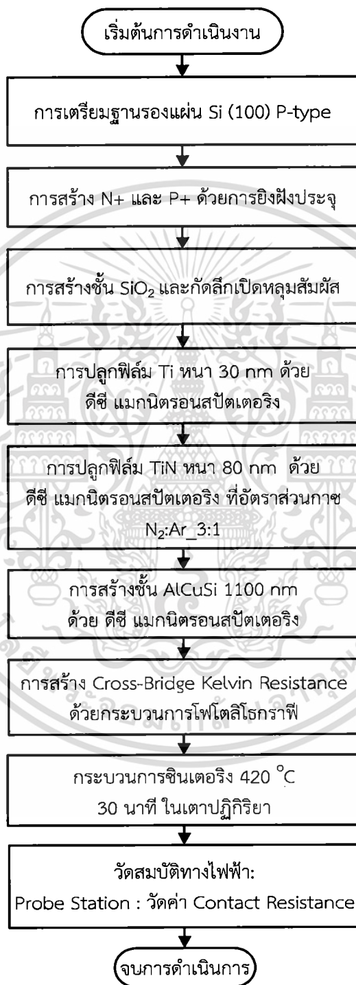
รูปที่ 3.22 แสดงผังงานของการสร้างโครงสร้างคอร์สปริตจ์เคลวินรีซิสแทนซ์เพื่อวัดความต้านทานรอยสัมผัส
