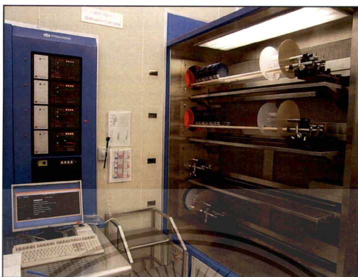
รูปที่ 3.15 ลักษณะเตาปฏิกรณ์ (Furnace) ของบริษัท Thermco System รุ่น TMX-10000 สำหรับกระบวนการซินเตอร์ริงและแอนโนลิ่ง
