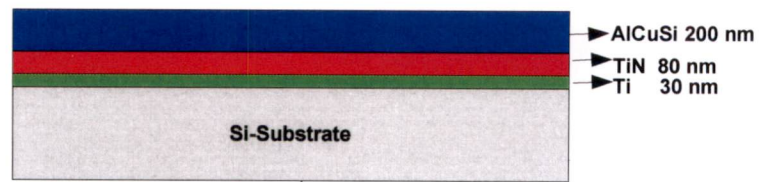
รูปที่ 3.18 การสร้างชั้นป้องกันการแพร่อลลอย AlCuSi ด้วยฟิล์ม TiN
