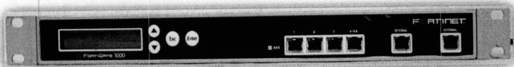
รูปที่ 3.13 แสดงอุปกรณ์ Firewall สำหรับการทำการพิสูจน์ตัวตน ยี่ห้อ Fortinet รุ่น Fortigate 1000
