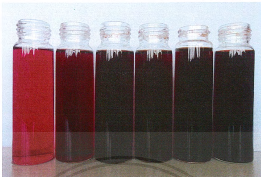
รูปที่ 4.9 สารละลายสีข้าวแดงที่ได้จากเชื้อราโมแนสค์สับที่อุณหภูมิ 30 องศาเซลเซียส เป็นระยะเวลา 5, 10, 15, 20, 25 และ 30 วัน ตามลำดับ (จากซ้ายไปขวา) สกัดด้วยเอทานอล 95 เปอร์เซ็นต์ 50 มิลลิลิตรต่อข้าวแดง 0.5 กรัม (น้ำหนักสด) เพื่อนำไปวัดปริมาณสีด้วยเครื่องสเปกโตรโฟโตมิเตอร์
