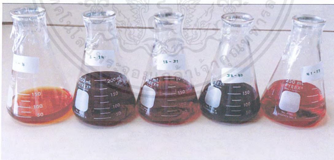
รูปที่ 4.15 สารสีที่ผ่านการแยกด้วยวิธี Column Chromatography
