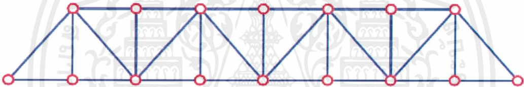
รูปที่ 2.9 แบบวอร์เรน (Warren Truss)
