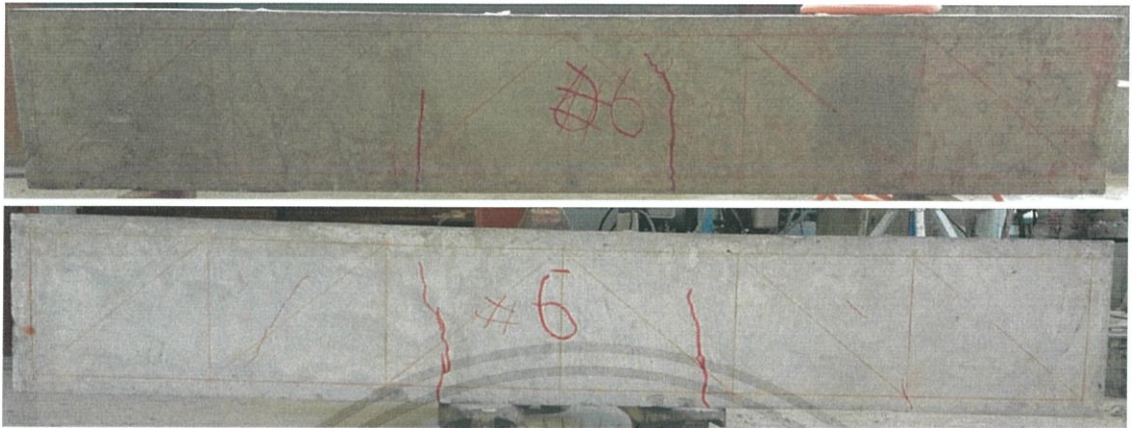
รูปที่ ก-6 ลักษณะการแตกหักของคานคอนกรีตเสริมเหล็กตัวที่ 6
