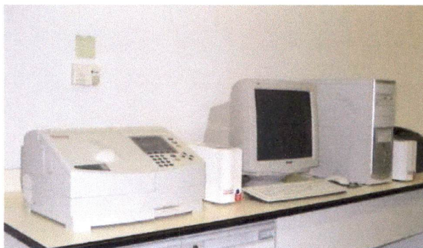
รูปที่ 3.9 เครื่อง UV-Vis Spectrophotometer รุ่น Helios α
