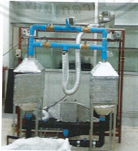
รูปที่ 3.3 เครื่องผลิตอากาศแห้งแบบต่อเนื่อง
