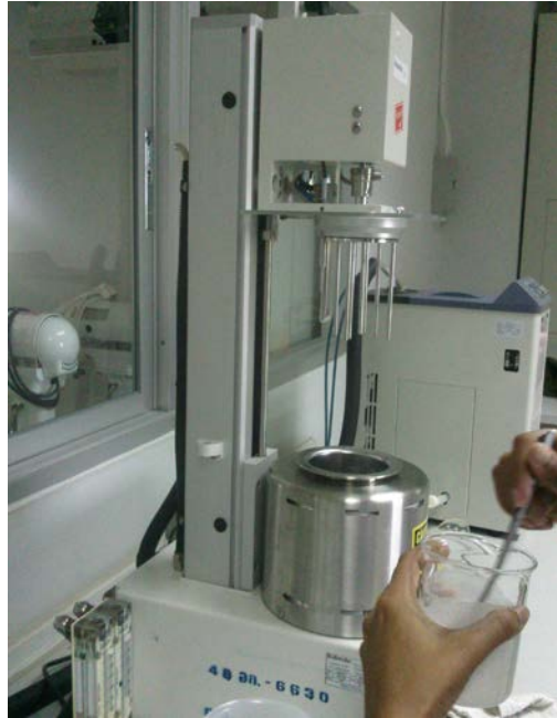
ภาพที่ ข.2 การวัด การเปลี่ยนแปลงควา มข้นหนืดของน้ำแป้งจาก ฟลาวร์และ สตาร์ช หัวัวจินใน ระหว่างการให้ความร้อนจนถึงการทำให้เย็น (pasting properties) ด้วยเครื่อง Brabender Visco-Amylograph
