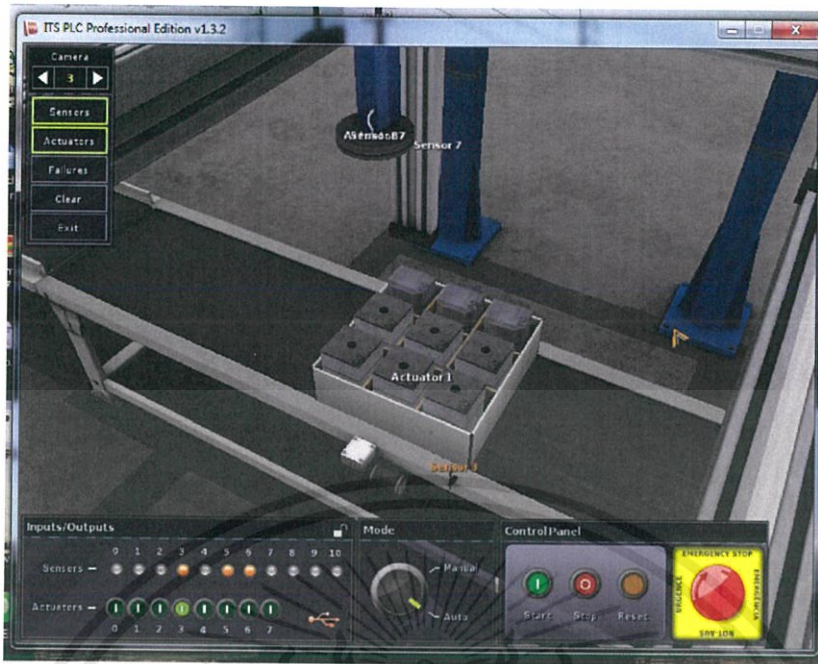
รูปที่ 4.7 กระบวนการบรรจุผลิตภัณฑ์ Type H ผ่านโปรแกรม ITS PLC
