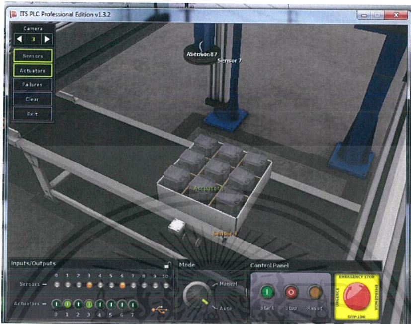
รูปที่ 4.5 กระบวนการบรรจุผลิตภัณฑ์ Type C ผ่านโปรแกรม ITS PLC
