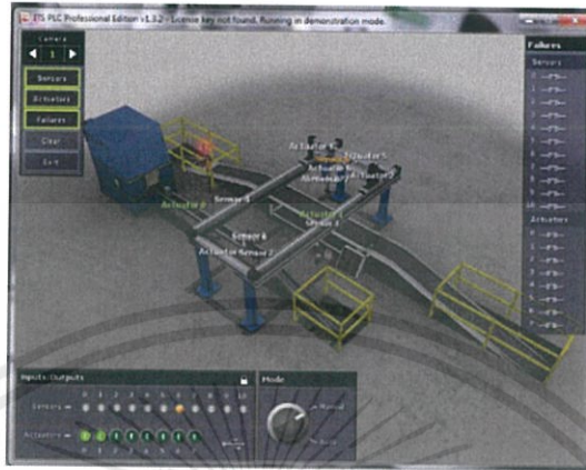
รูปที่ 3.11 แผงควบคุมระบบจำลองการทำงาน (System Panels)
