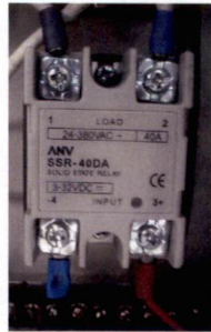
รูปที่ 4.7 โซลิดสเตทรีเลย์ รุ่น SSR-40DA
