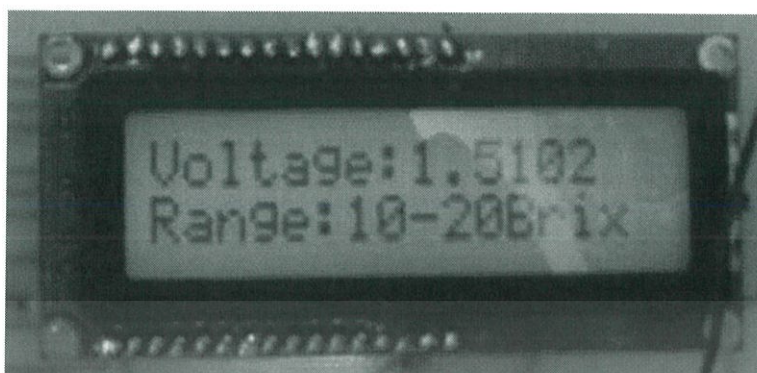
รูปที่ 4.21 หน้าจอแสดงผลช่วงความหวาน 10-20 Brix
