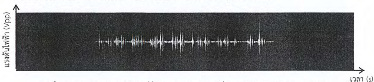
รูปที่ 4.8 กราฟแรงดันจากรถไฟที่วิ่งผ่านเลน 1 (ติดมวลที่ปลายเพียโซอิเล็กทริก 10 กรัม)
