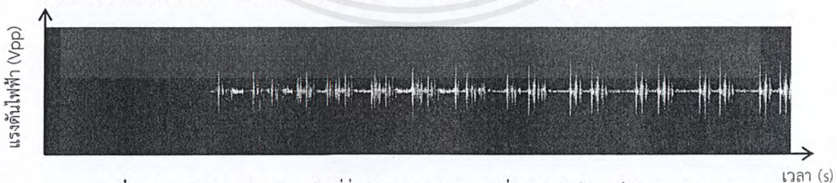
รูปที่ 4.10 กราฟแรงดันจากรถไฟที่วิ่งผ่านเลน 4 (ติดมวลที่ปลายเพียโซอิเล็กทริก 10 กรัม)
