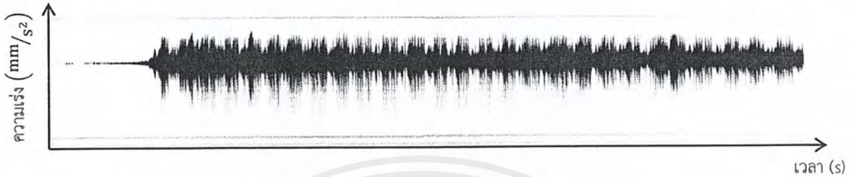
รูปที่ 4.16 กราฟความเร่งจากรถไฟที่วิ่งผ่านเลน 4
