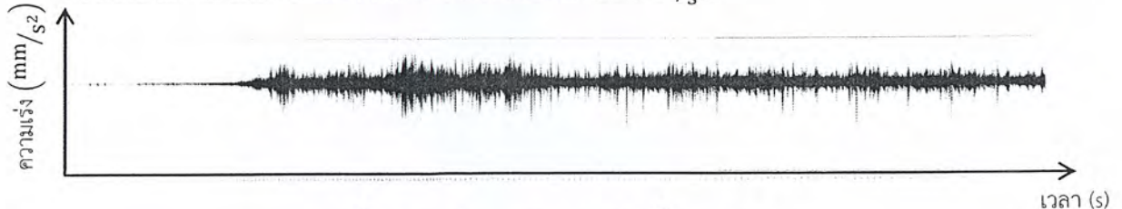
รูปที่ 4.4 กราฟความเร่งจากรถไฟที่วิ่งผ่านเลน 4
