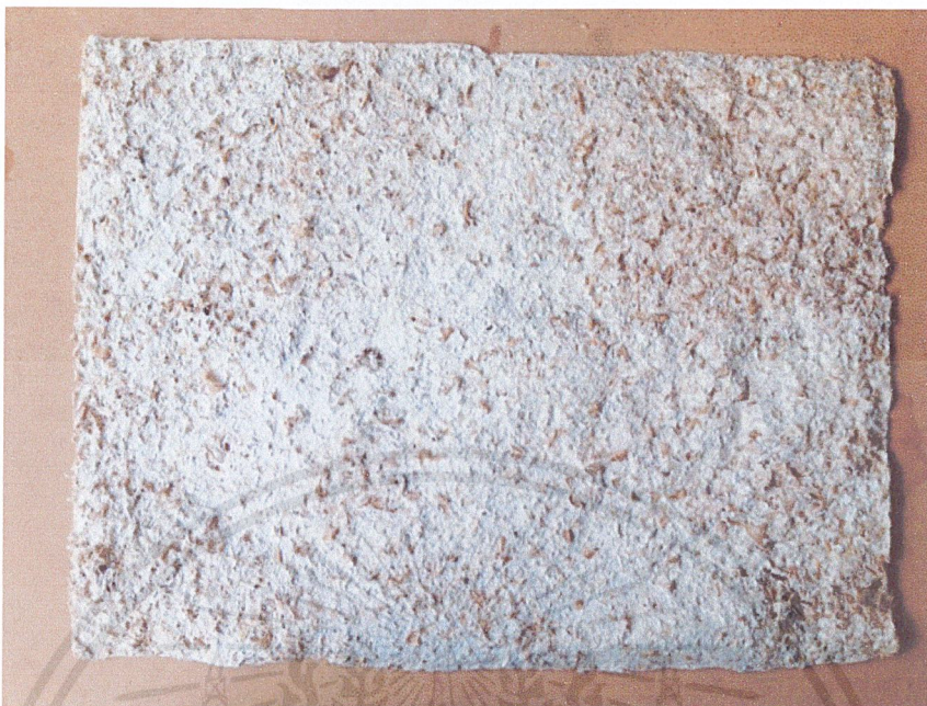
ภาพที่ 9 เปลือกสับปรดที่ผสมกระดาษขุจะยัดกระดาษเป็นแผ่นได้ดี สามารถพับได้
