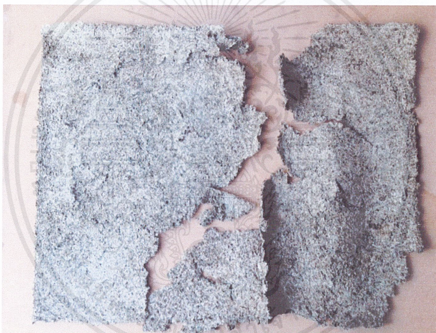
ภาพที่ 6 เปลือกมะม่วงที่ผสมกระดาษทิชชูเมื่อแห้งจะมีการหดตัวและทำให้ฉีกจากกัน
