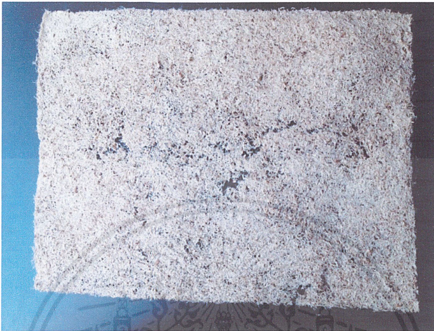
ภาพที่ 11 เปลือกสับปรดที่ไม่ผสมกระดาษที่ชงจะเปราะบางขาดง่าย
