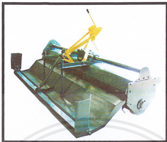
ภาพที่ 39 ขลุบหมุนติตรถแทรกเตอร์ขนาดเล็ก
