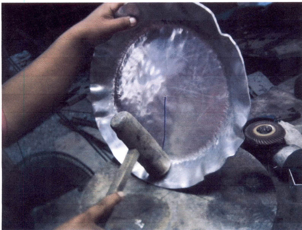
17. ขึ้นรูปด้วยค้อนด้านใน จำนวน 4 ชั้น
