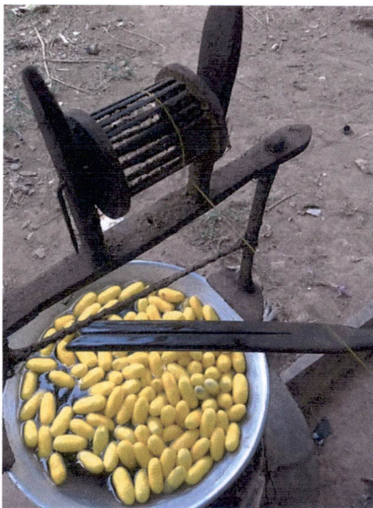
รูปที่ 2.52 พวงสาวและไม้ทียบสำหรับดึงเส้นไหมจากรังไหมที่ต้ม
