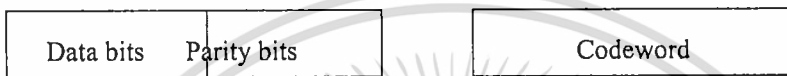
รูปที่ 2.3 รูปแบบของรหัส ก) รหัสระบบ ข) รหัสไม่เป็นระบบ
